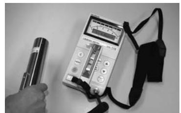
「シンチレーションサーベイメータ」写真11台を借り活用しています。ポケット線量計は会員が1週間ごとに測定しています。
