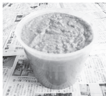
自家栽培の作物は、放射能測定が欠かせない。フードプロセッサーでペースト状にしてから測定器にかけ、パソコン画面でチェックする
