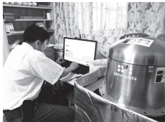
自家栽培の作物は、放射能測定が欠かせない。フードプロセッサーでペースト状にしてから測定器にかけ、パソコン画面でチェックする
